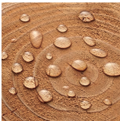
ウッドエイド ボロンテック 塗布 (撥水あり)
